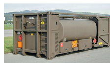
Container di rifornimento carburante (CRC)
